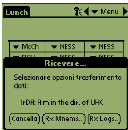
Figura 2: per scaricare la configurazione dell'armadio, tenere il palmare parallelo al pavimento a circa 30 cm dalla lente ricevente dell'armadio nell'angolo in alto a destra. Toccare il pulsante Rx Mnems. Per scaricare il log dell'attività giornaliera, toccare il pulsante Rx Logs. Completato il trasferimento, si visualizza una finestra di dialogo.
